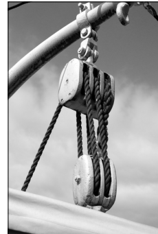
滑車（ロープをかけた車輪） ロープを引いて持ち上げる 写真：Ludovic Péron (CC BY-SA 3.0)。Wikimedia Commons より、 白黒にして名前を加えた
