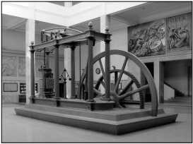
ワット式の蒸気機関 (1832年にイギリスでつくられた物) 写真：Nicolás Pérez (CC BY-SA 3.0)。 Wikimedia Commons より、白黒にした
